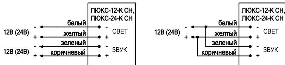
Рис. 1. Схема подключения
