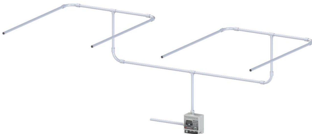
Рисунок 5 – Воздухозаборный трубопровод с 4 симметричными ветвями
