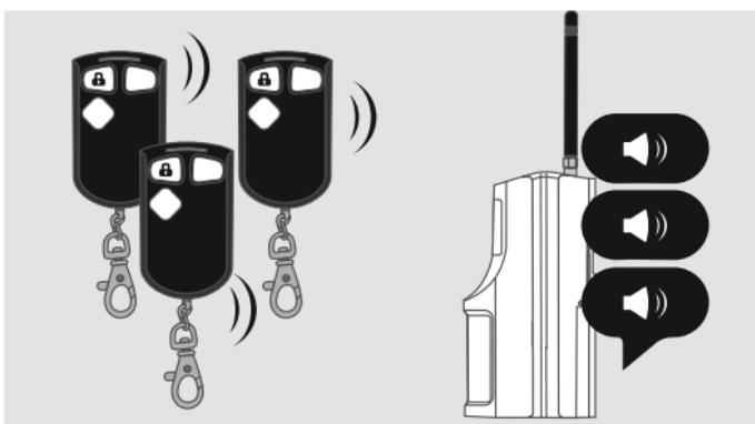
Добавьте сирену. Извлеките защитную пластину возле батареи питания сирены. Светодиоды сирены вспыхнут. Дождитесь звукового сигнала сигнализатора и звуковой и световой индикации сирены.
