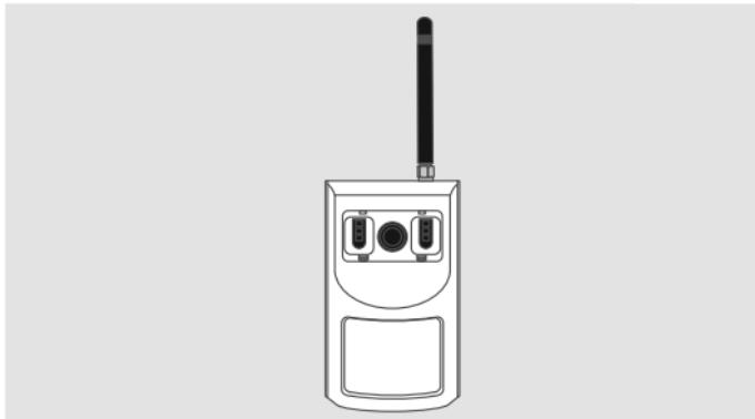
Направьте объектив сигнализатора на входную дверь и поставьте сигнализатор на охрану. Нажмите на 1-2 секунды на брелоке кнопку . Брелок мигнет желтым, потом красным.
