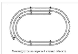
Примеры размещения устройств пожаротушения «Парабола»
