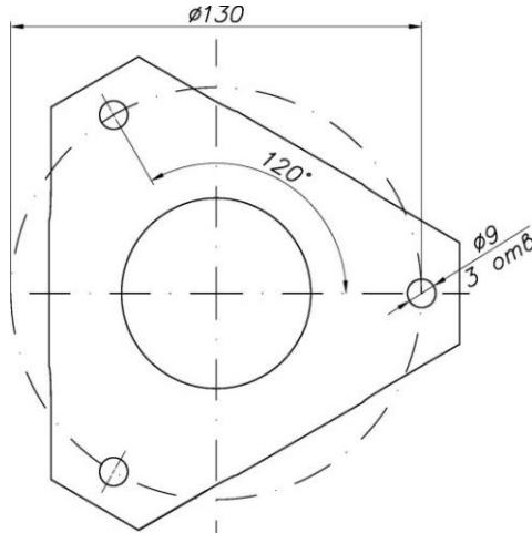
Рисунок 2 - Координаты крепёжных отверстий кронштейна модуля
